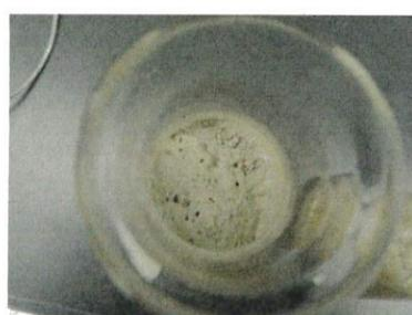
約5mlずつ、滴下したが、塩酸のみ、シュワシュワ音がして、気体発生していた。また、滴下後のようすも塩酸のみ異なる。念のためそれぞれのpHも調べた。また、磁鉄鉱が含まれないかと磁石を近づけたが反応なかった。そこで塩酸を加えて発生した気体について調べることにした。
