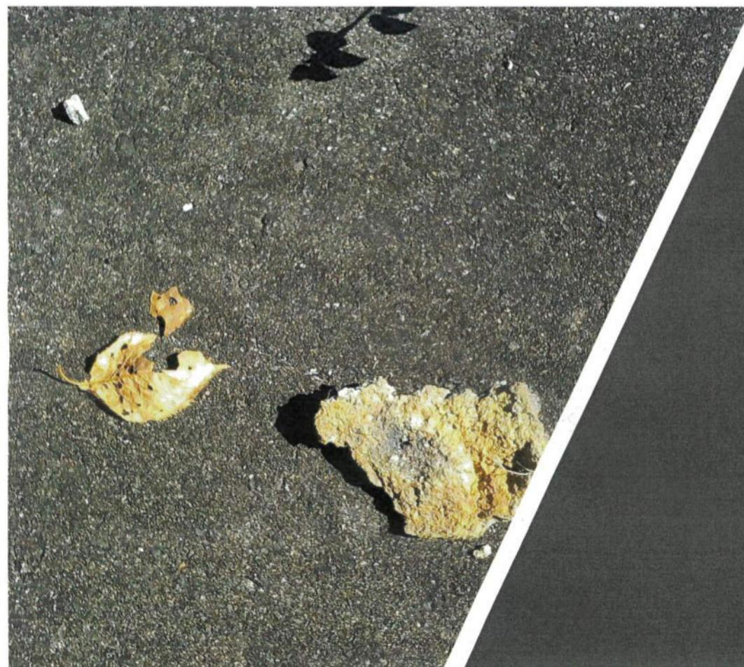
岩石の一部が風化によって欠けたものを実験に使用する
